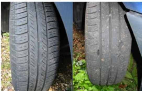
Effet de l'usure sur un pneu
