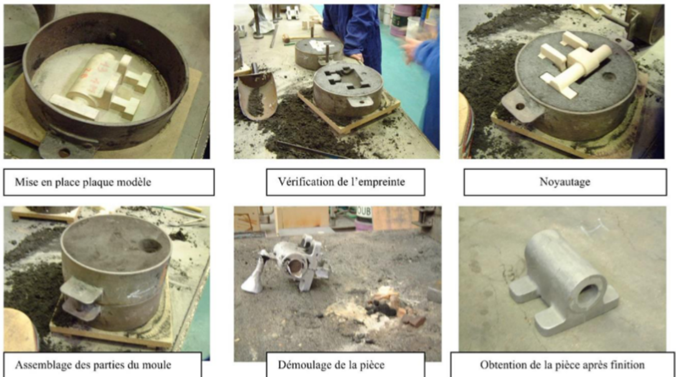
FIGURE 5 – Moulage à moule au sable
