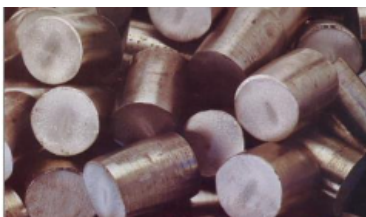
(a) Lopin (pièce que l'on va déformer)
