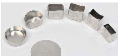
(a) Différentes étapes de l'emboutissage
